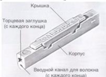
Рис. 3. Соединитель фирмы «ЗМ» Fibrlok
