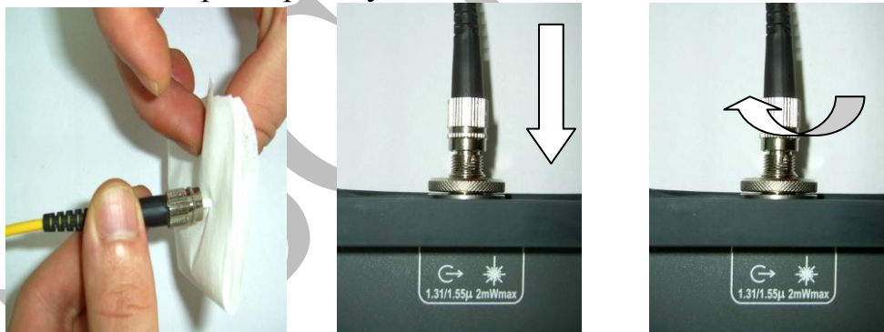
Рис. 5. Этапы подключения разъемов типа FC/PC
