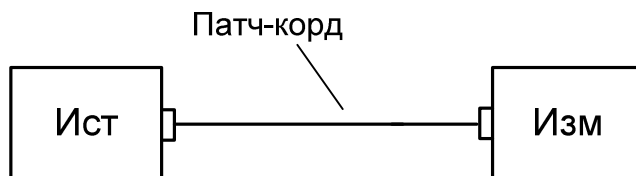
Рис. 1 - Схема определения опорного уровня источника
