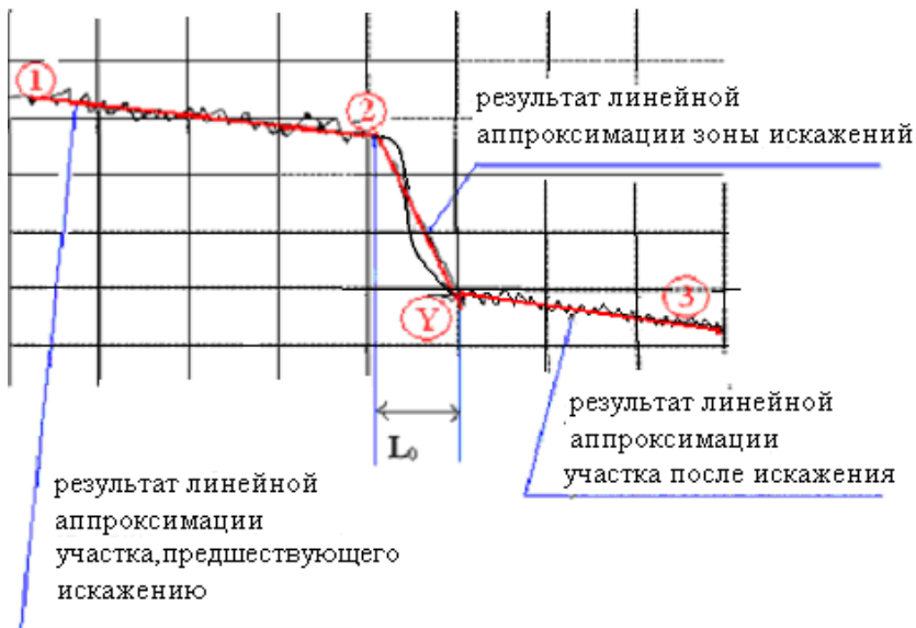
Рис.5 Принцип определения протяженности «мертвой» зоны L_0 на неотражающей неоднородности
