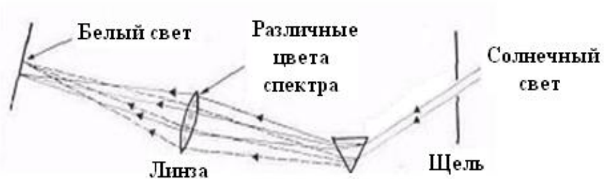
Рис. 1.1. Схема опыта И. Ньютона
