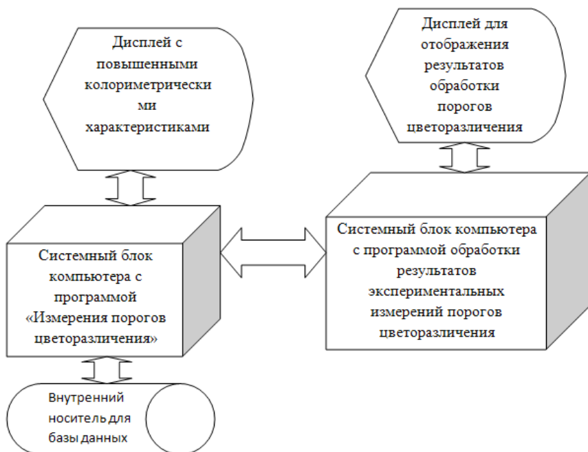
Рис. 7.2. Структурная схема аппаратно-программного комплекса измерения и обработки результатов измерения порогов цветоразличения
