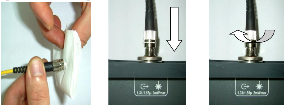
Рис. 2 – Этапы подключения разъемов типа FC/PC
