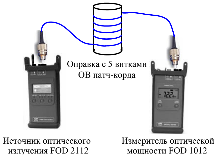
Рис. 3 – Схема измерения вносимых потерь ОВ на макроизгибе
