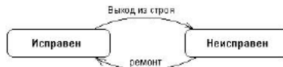
Рис. 17. Простейший пример диаграммы состояний для технического устройства типа компьютер
