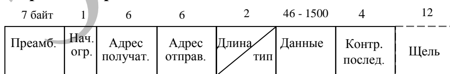
Рисунок 2.1. Формат кадра Ethernet
